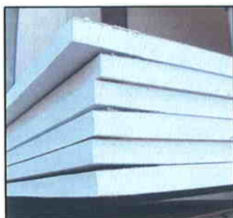
Imágenes 6, 7 y 8 Placas de yeso laminado y su encolado sobre el panel
