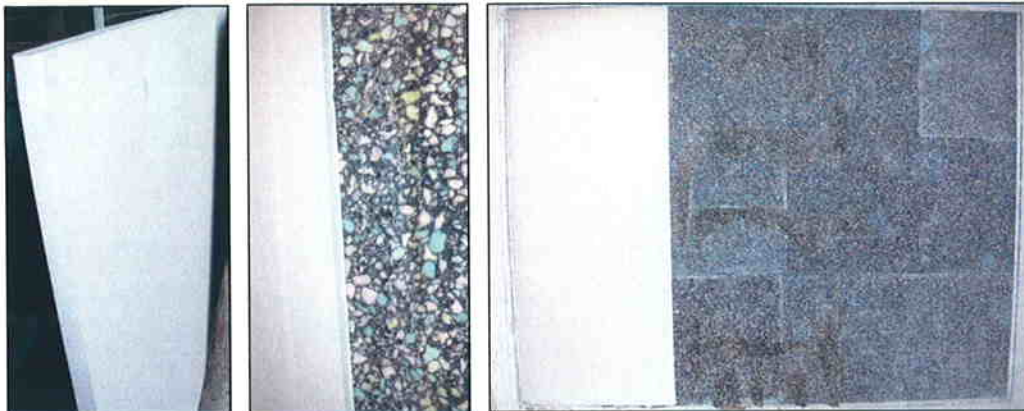
Imágenes 10, 11 y 12 Placa de yeso laminado y su encolado sobre el panel
